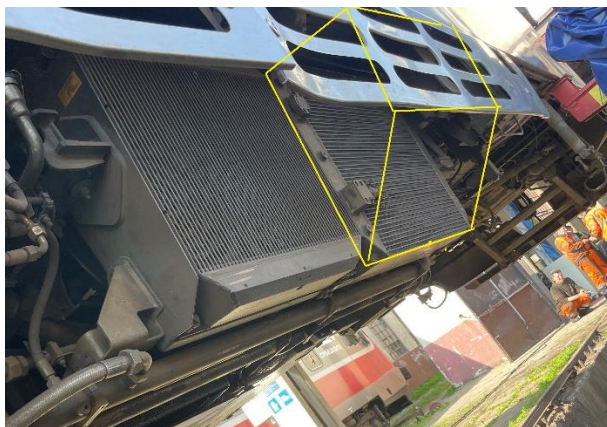
Slika 9: Ilustracija idejnog rešenja usisnog vazdušnog kanala
