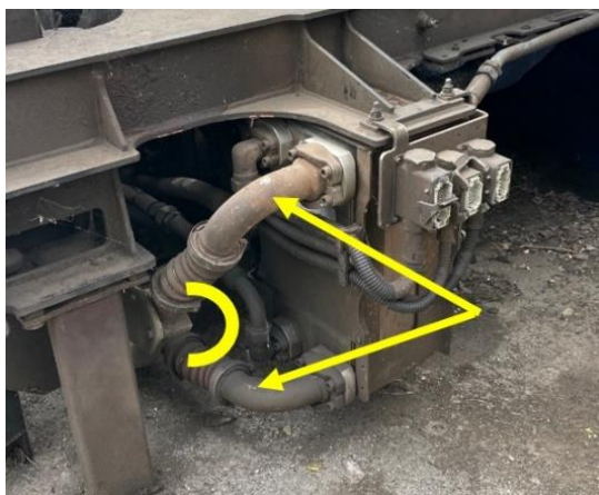
Slika 5: Izgled razmenjivača toplote za hlađenje hidrauličnog ulja sa tačkama priključenja cevovoda
